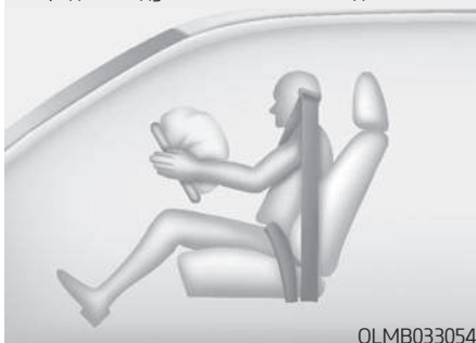
■ Передняя подушка безопасности водителя (1)
