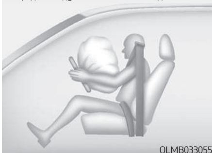
■ Передняя подушка безопасности водителя (2)
