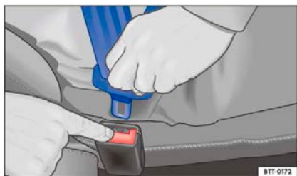
Рисунок 25. Высвобождение язычка из замка ремня безопасности.
