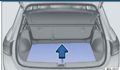
Рисунок 109 Внутри багажника: открываемый пол багажника
