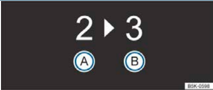
Рисунок 77 Дисплей приборной панели: рекомендации по выбору передачи (схематическая диаграмма)
