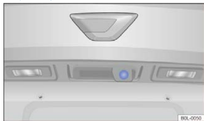
Рисунок 150 На двери багажника: камера заднего вида (схематическое изображение)
