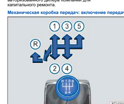
Рисунок 83 Схематическая диаграмма положения передач 5-ступенчатой механической коробки передач
