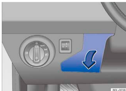
Рис. 116 Приборная панель со стороны водителя: крышка блока предохранителей
