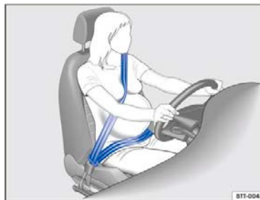
Рисунок 27. Правильное положение ремней безопасности для беременных
