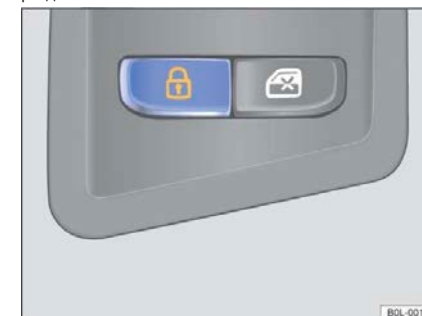
Рисунок 43 Дверь со стороны водителя: кнопка центрального замка двери
