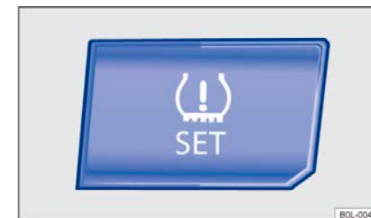
Рисунок 136 Центральная консоль: кнопка контроля давления в шинах
