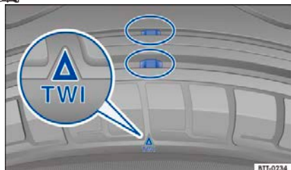
Рисунок 140 Протектор шины: маркировка износа (схематическое изображение)
