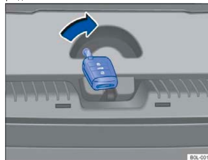
Рисунок 50 Внутри багажника: отпирание замка двери багажника
