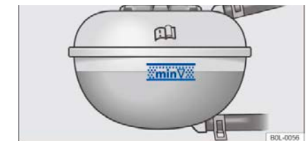
Рисунок 131 В моторном отсеке: Маркировка расширительного бачка охлаждающей жидкости двигателя (схематическое изображение)
