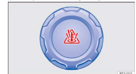
Рисунок 132 В моторном отсеке: Крышка бачка охлаждающей жидкости двигателя (схематическое изображение)
