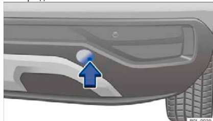
Рисунок 121 Верхняя правая сторона заднего бампера: снимите крышку
