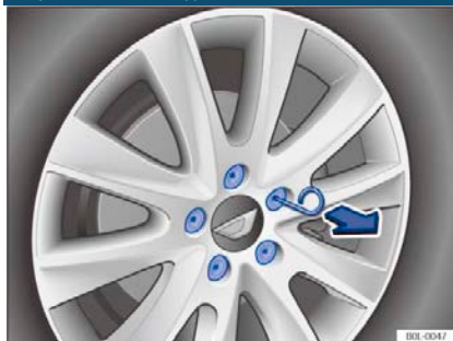
Рисунок 144. Снятие защитного колпачка с колесного болта (схематическое изображение)
