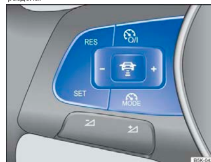
Рисунок 89 Левая сторона многофункционального рулевого колеса: кнопка управления ограничителем скорости
