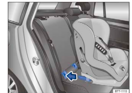
Рисунок 36 Схематическая диаграмма: установка детского сиденья ISOFIX с удерживающими рычагами
