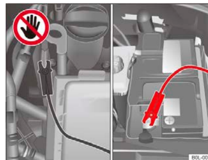
Рисунок 135 Моторный отсек: разъем для зарядного устройства или вспомогательного пускового кабеля
