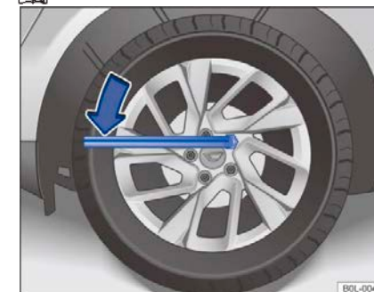
Рисунок 145. Замена колеса: ослабление колесных болтов
