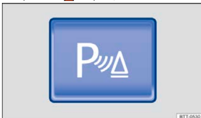
Рисунок 97 Центральная консоль: кнопка включения/выключения системы предупреждения о превышении дистанции (схематическое изображение)
