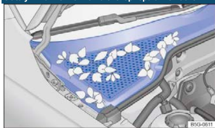
Рисунок 149 Между моторным отсеком и лобовым стеклом: сливная канавка (схематическое изображение)
