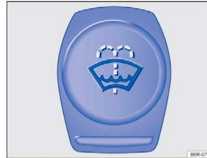
Рисунок 128 В моторном отсеке: крышка бачка стеклоомывателя
