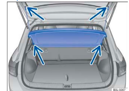
Рисунок 108 В багажнике: снять и установить шторку багажника
