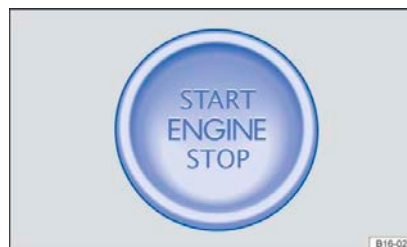
Рисунок 80 Нижняя часть центральной консоли: кнопка запуска/остановки двигателя
