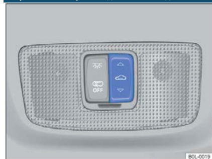
Рисунок 51 Потолок: кнопки сдвижного/откидного люка Переключение, открытие и закрытие сдвижного/откидного люка
