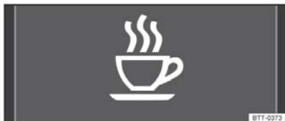
Рисунок 11 Дисплей приборной панели: символ предупреждения об усталости водителя
