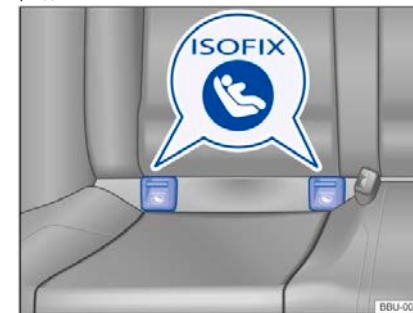
Рисунок 35 Маркировка крепления ISOFIX для детских кресел
