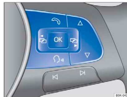
Рисунок 16 Правая сторона многофункционального рулевого колеса: клавиши управления меню приборной панели и информационного дисплея (данный тип приведен только в качестве примера)
