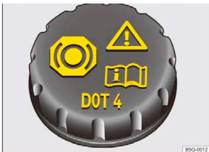
Рисунок 133 В моторном отсеке: крышка бачка с тормозной жидкостью
