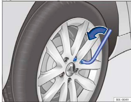
Рисунок 148 Замена колеса: откручивание колесных болтов с помощью торцевого ключа для колесных болтов
