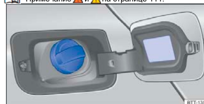
Рисунок 111 Крышка заливной горловины с открытой крышкой топливного бака
