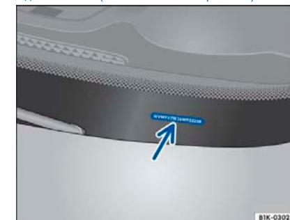
Рисунок 154 На лобовом стекле: Идентификационный код автомобиля
