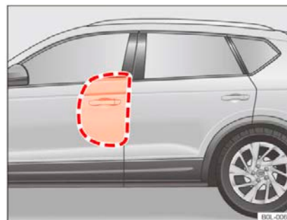
Рисунок 30 Левая сторона автомобиля: зона действия боковой подушки безопасности
