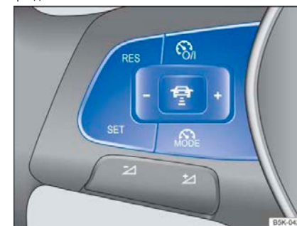
Рисунок 93 Левая сторона многофункционального рулевого колеса: кнопка управления ACC
