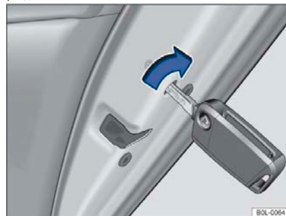
Рисунок 46 Торцевая часть правой двери: запирание автомобиля механическим ключом
