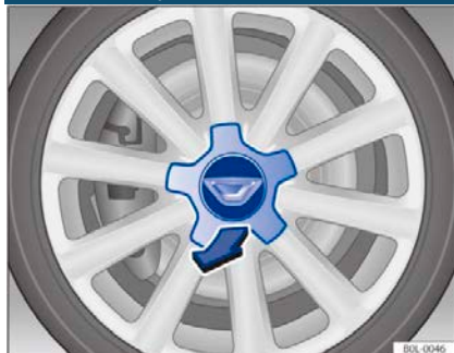
Рисунок 143. Снятие центральной накладки колеса
