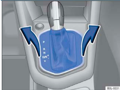
Рисунок 86 Снятие крышки гнезда переключения передач
